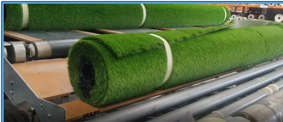
(Photo n°36 : Vue de la bobine sur les rouleaux du dérouleur)
