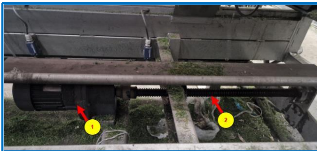
(Photo n°05 : Vue du motoréducteur et de la vis sans fin)
