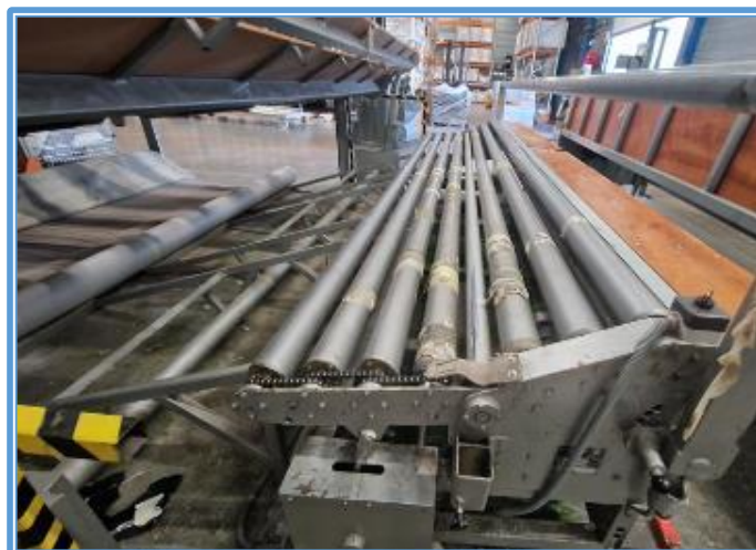
(Photo n°43 : Vue de l'évacuation de la bobine)
