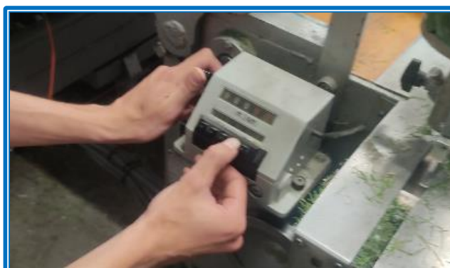
(Photo n°38 : Vue du compteur mètreur mécanique)
