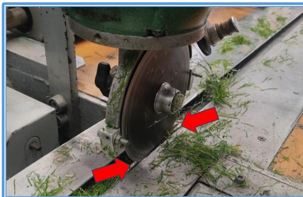
(Photo n°57 : Vue des parties travaillantes du couteau rotatif)
