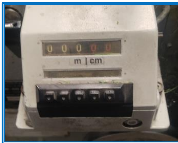
(Photo n°44 : Vue du compteur mètreur mécanique)
