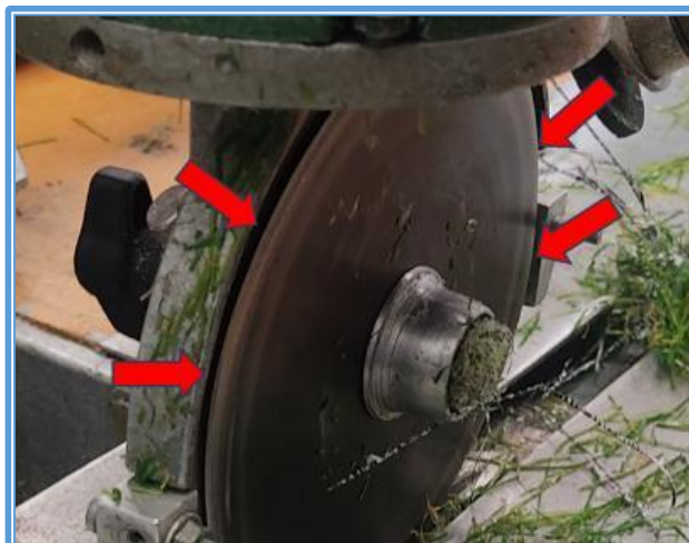
(Photo n°58 : Vue des parties non travaillantes du couteau rotatif)
