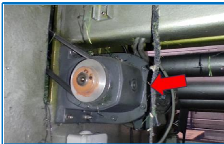
(Photo n°12 : Vue du motoréducteur entraînant le chariot)
