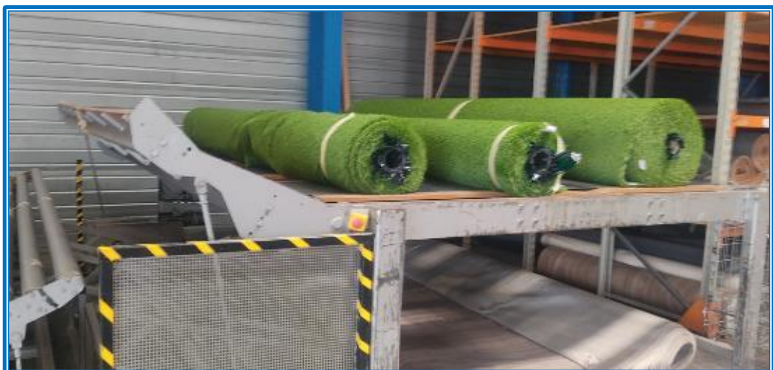
(Photo n°35 : Vue de la mise en place des bobines sur le convoyeur à bandes)
