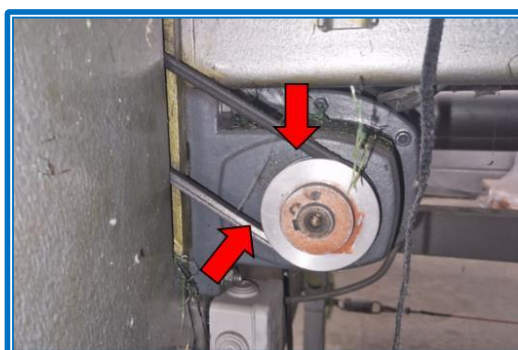
(Photo n°53 : Vue de la poulie et courroie du système d'entraînement du chariot de découpe)
